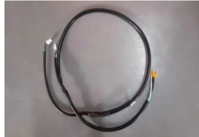
Netzwerkabel der Gehäuseabschnitte „C“, „D“ und „E“
