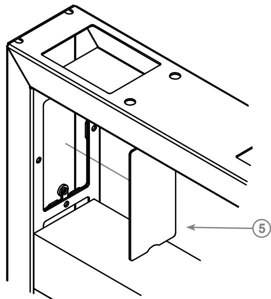
Setzen Sie die magnetischen Blenden (5) auf der Innenseite des Rahmens ein.
