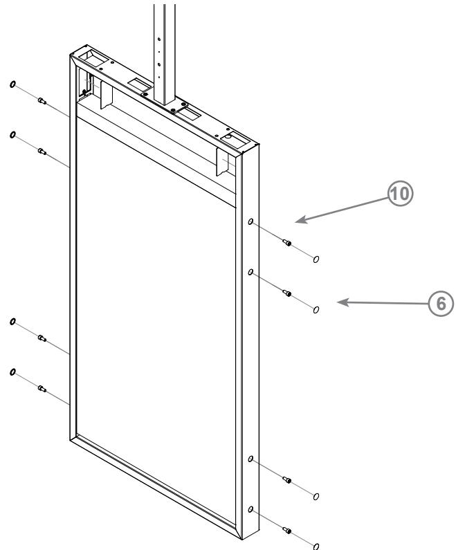
Platzieren Sie nun den OMN-D-Screen in der Halterung, verwenden Sie zur Fixierung die M8x18-Schrauben (10). Drücken Sie anschließend die Abdeckungen (6) in die Öffnungen.
