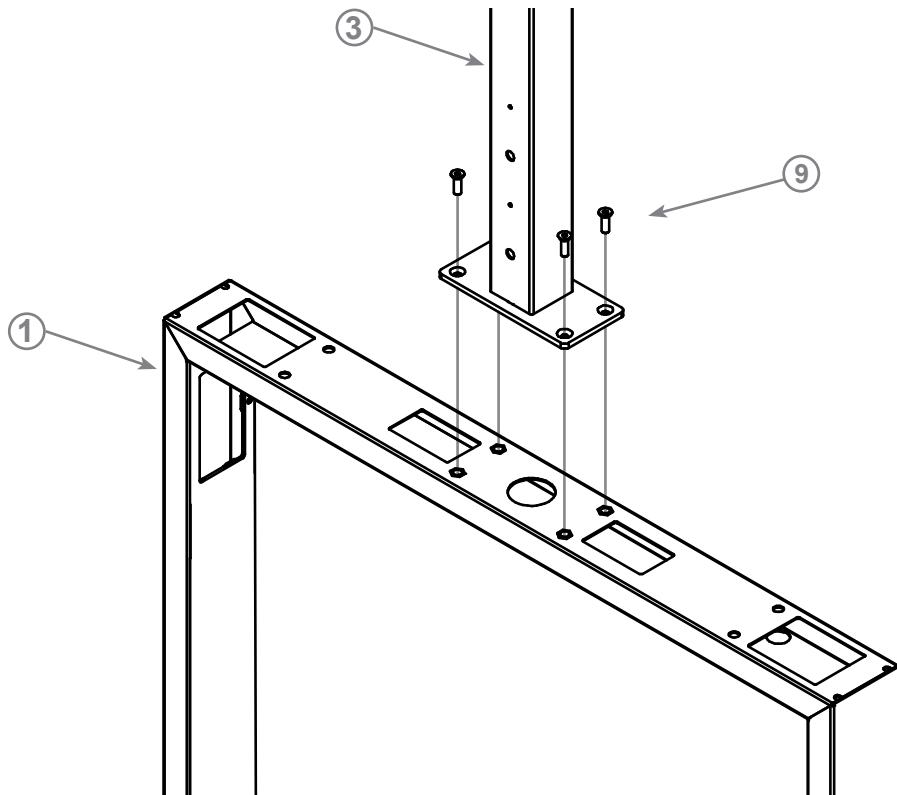
Verschrauben Sie den vormontierten Rahmen (1) mit dem Teleskoprohr (3), verwenden Sie dafür die M6x20-Schrauben (9).
