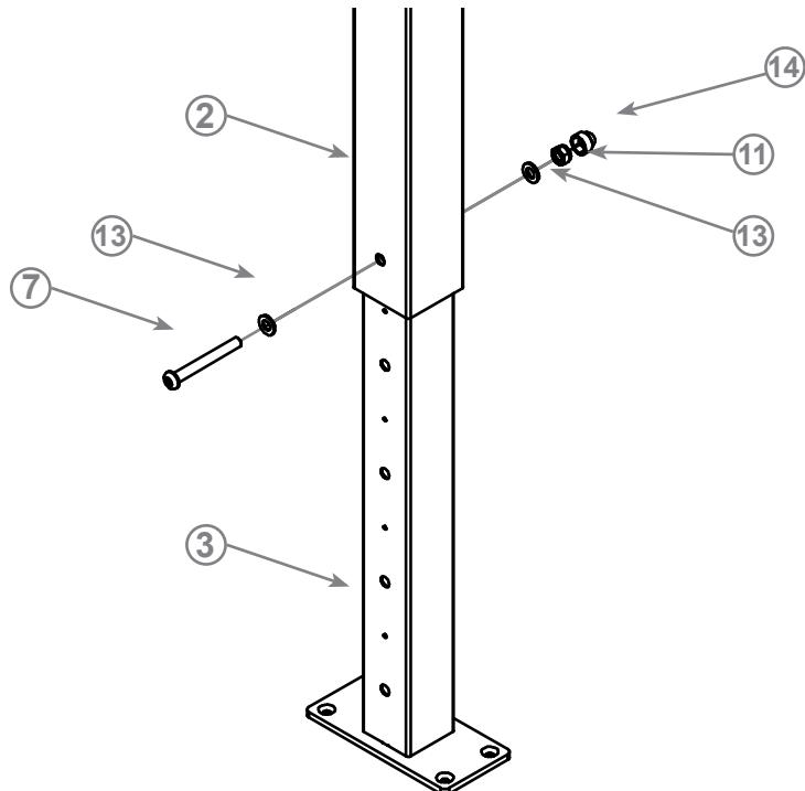
Schieben Sie den inneren Teil des Teleskoprohres (3) in den oberen Teil (2). Schieben Sie dann die Fixierschraube M8x70 (7) durch die vorgebohrte Öffnung. Verschrauben Sie diese von der Gegenseite mit einer Unterlegscheibe (13) und einer Schraubenmutter (11). Stülpen Sie die Abdeckkappe (14) über die Mutter.
