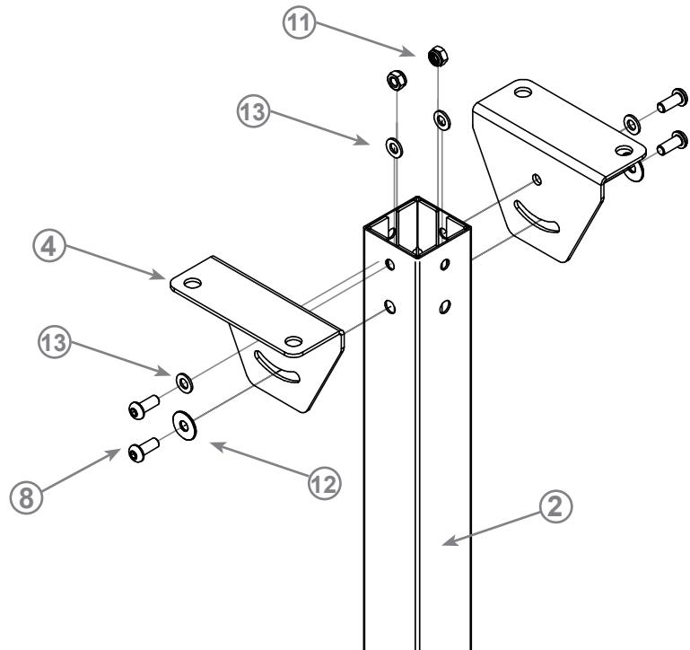
Verschrauben Sie die 2-teilige Deckenaufnahme (4) mit dem oberen Teil des Teleskoprohres (2). Fixieren Sie von innen mit Schraubenmuttern (11) und Unterlegscheiben (13) und außen mit Unterlegscheiben (12), Unterlegscheiben (13) sowie M8x20-Schrauben (8).
